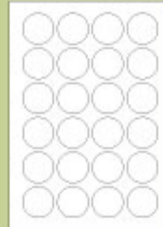
Stanzform Nr.: 03 Format: Ø 40 mm Etiketten / Bogen: 24 Stück Blattgröße: DIN A4
